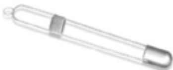
Bild 1: Auslaufbecher Figure 1: Zahn Cup (www.wikipedia.org, 2010)
