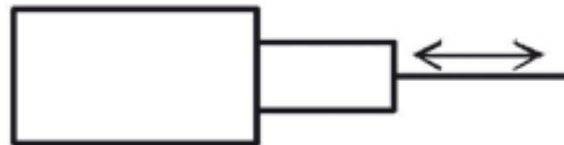
Bild 3: Die Funktion dieses Viskositätssensors beruht auf einem vibrierenden Stab.
